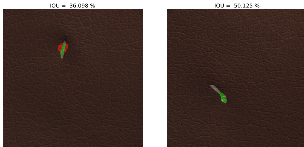
(a) Výsledek segmentace random walker je kulatější, než samotná vada, protože inicializace je elipsovitá.
