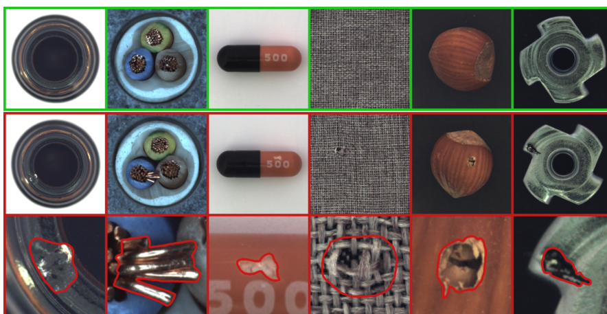
■ Obrázek 4.1 Ukázka objektů a defektů objevujících se v datasetu MVTEC [29]. První řádek obsahuje obrázky bez vady. Ve druhém řádku se na objektu objevuje vada. Ve třetím řádku je pak ta samá vada přiblížena a kolem vady je nakreslená kontura.
