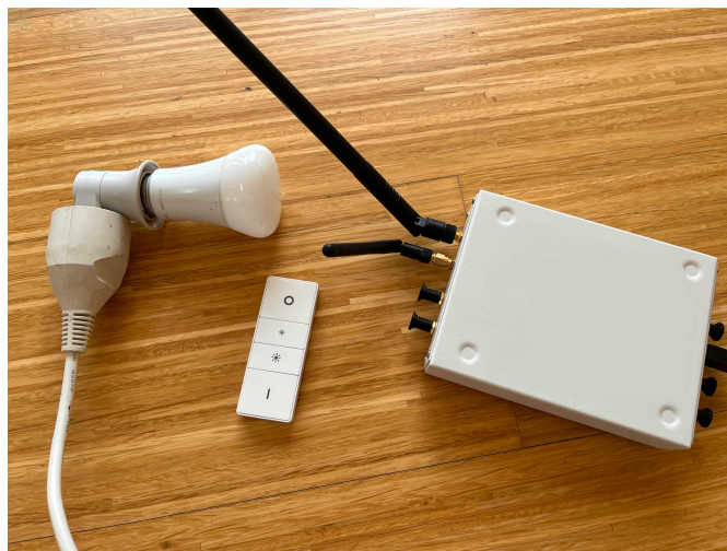
■ Obrázek 6.1 Testovací zařízení sestávající z žárovky Philips LWB004 s firmwarem verze 5.127.1.26420, dálkového ovladače Philips 324131137411 a SDR Ettus USRP B210 použitého při testování našeho nástroje zigtoucher pro bezpečnostní analýzu ZigBee Touchlink
