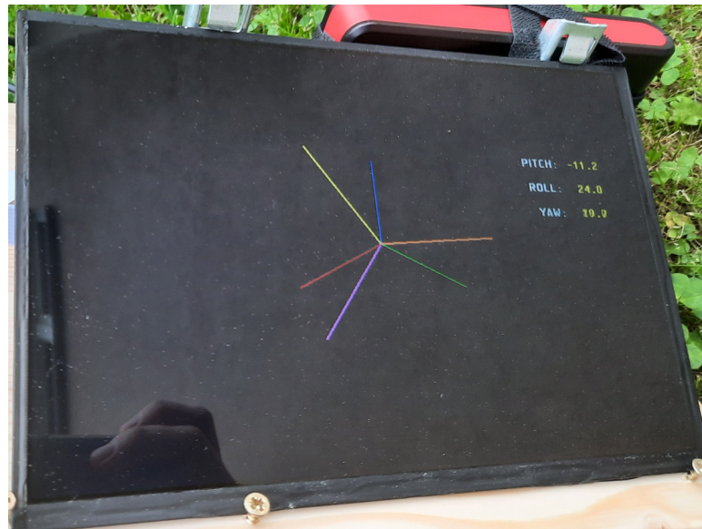
Obrázek 5.6: Zobrazení vektorů v technické izometrii a číselných hodnot
