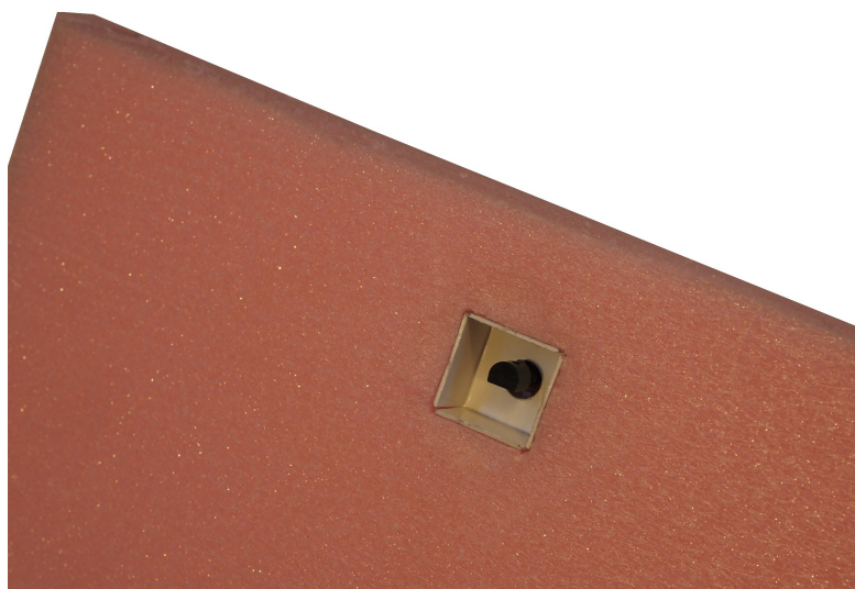
Obrázek 32: Detail původního způsobu zabudování senzoru teploty v komoře
