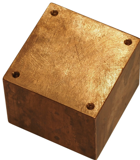
Obrázek 28: Vyhlazený měděný blok s otvory pro přichycení vnitřního chladiče
