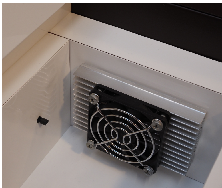
Obrázek 33: Detail konečného umístění senzoru teploty v komoře
