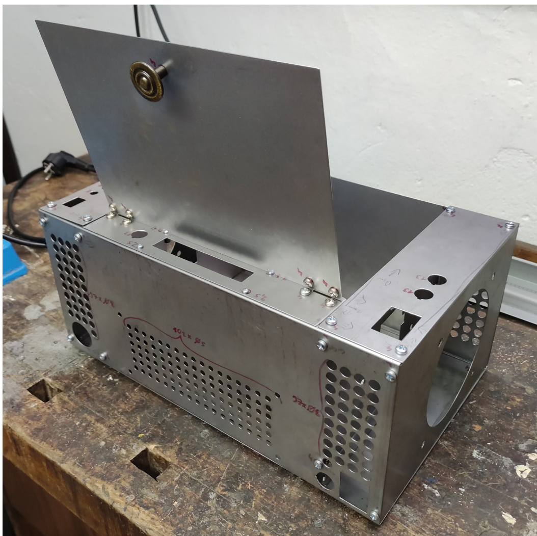
Obrázek 24: Zkušebně sestavená skříň komory – zezadu otevřená
