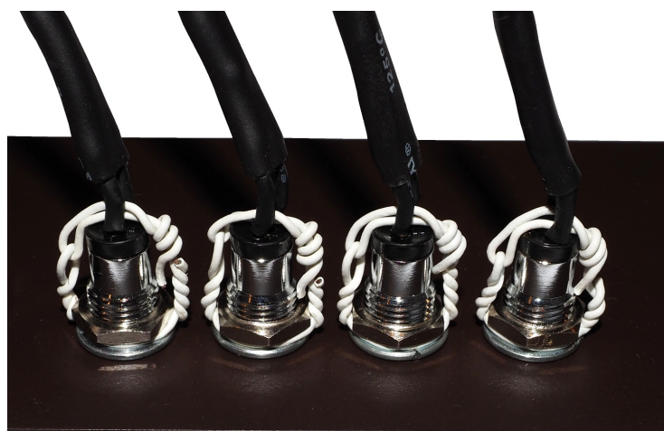
Obrázek 35: Detail zabudovaného koncového spínače - kolmý pohled
