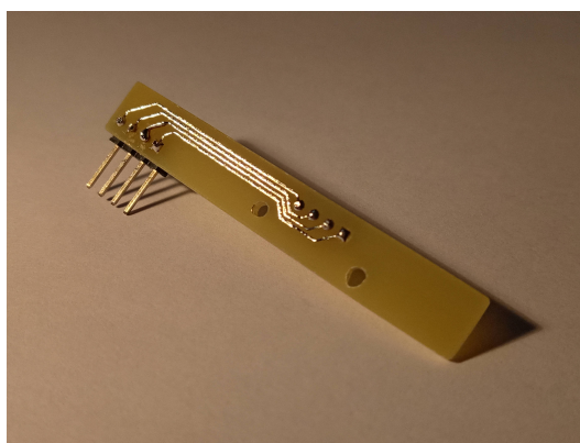
Obrázek 3.6: Propojovací deska. Nahoře je konektor pro kabel do řídicí desky, uprostřed jsou připájeny kontaktní piny.
