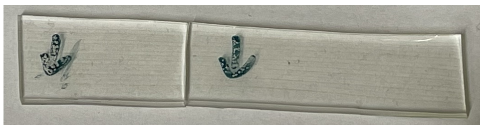
Obrázek 6.19: Vytvrzený vlnovod se šesti kanálky o průměru přibližně 500 \mu\text{m} Sylgard 184 (plášť), LS-6943 + 0,01 hm. % BASF (jádro).
