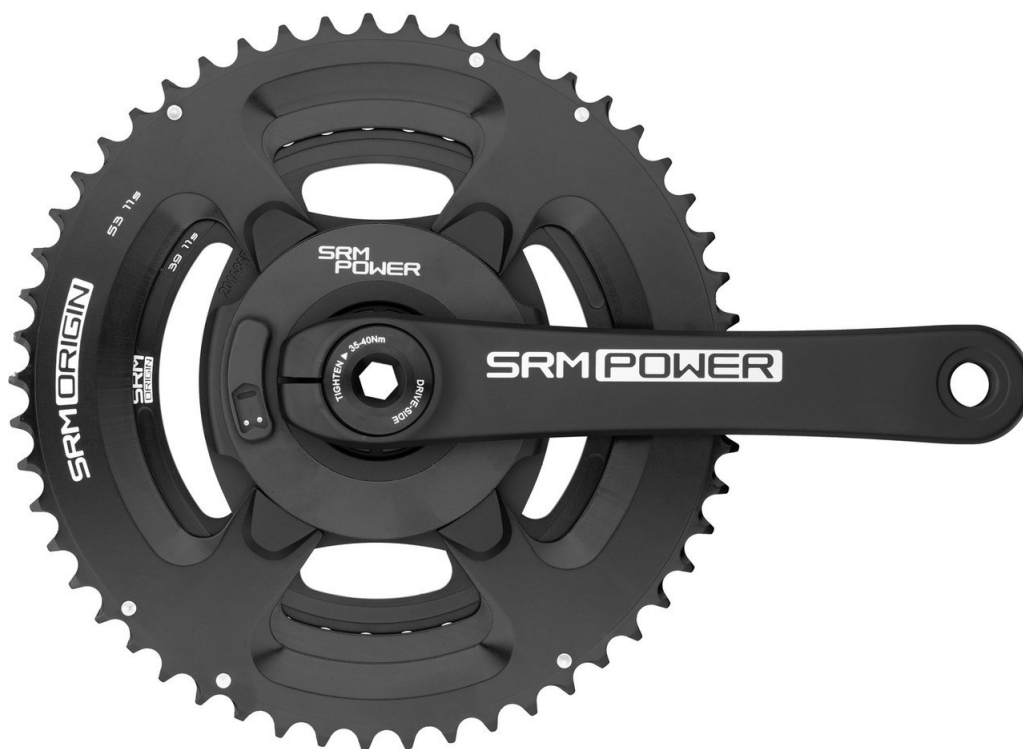
Obrázek 3: Wattmetr SRM Origin [10]
