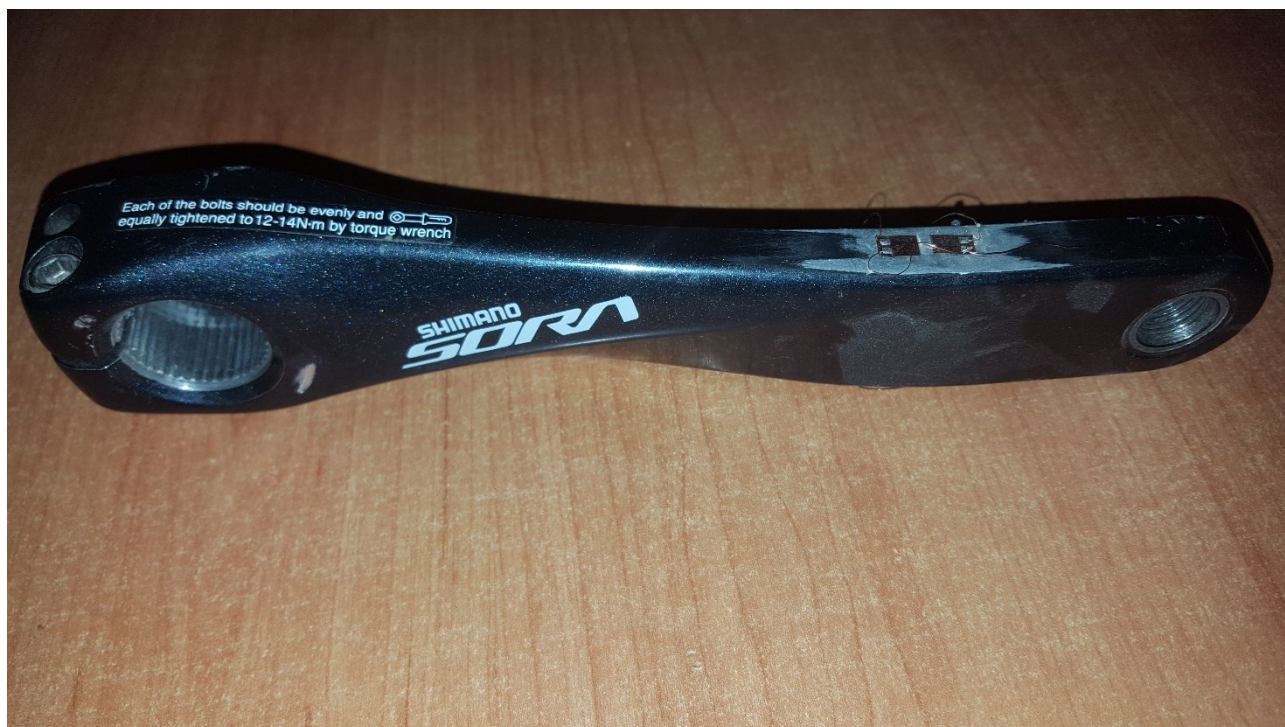
Obrázek 11: Pokusná klika s nalepenými tenzometry
