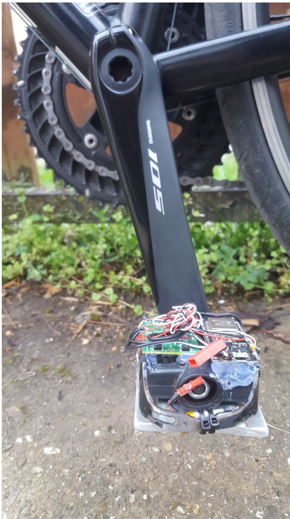
Obrázek 23: Měřicí zařízení nainstalované klíče silničního kola
