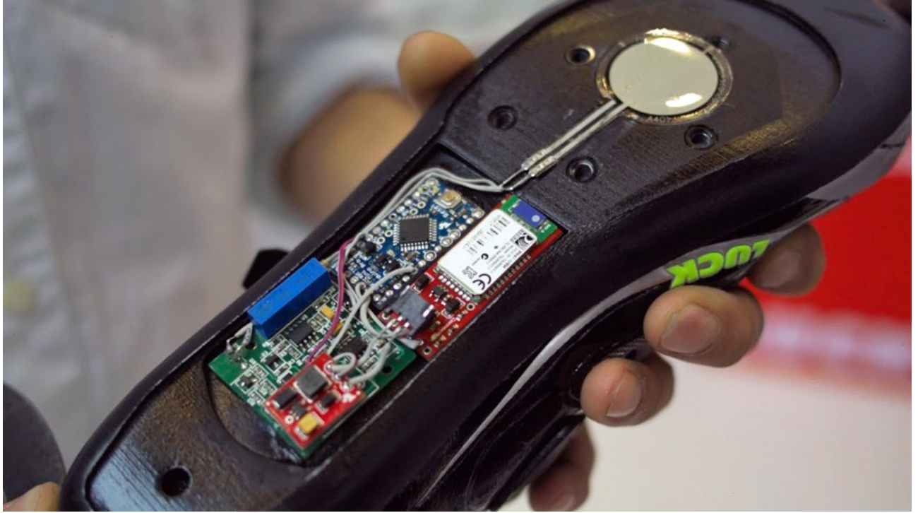
Obrázek 7: Pohled na elektroniku wattmetru firmy Luck [19]
