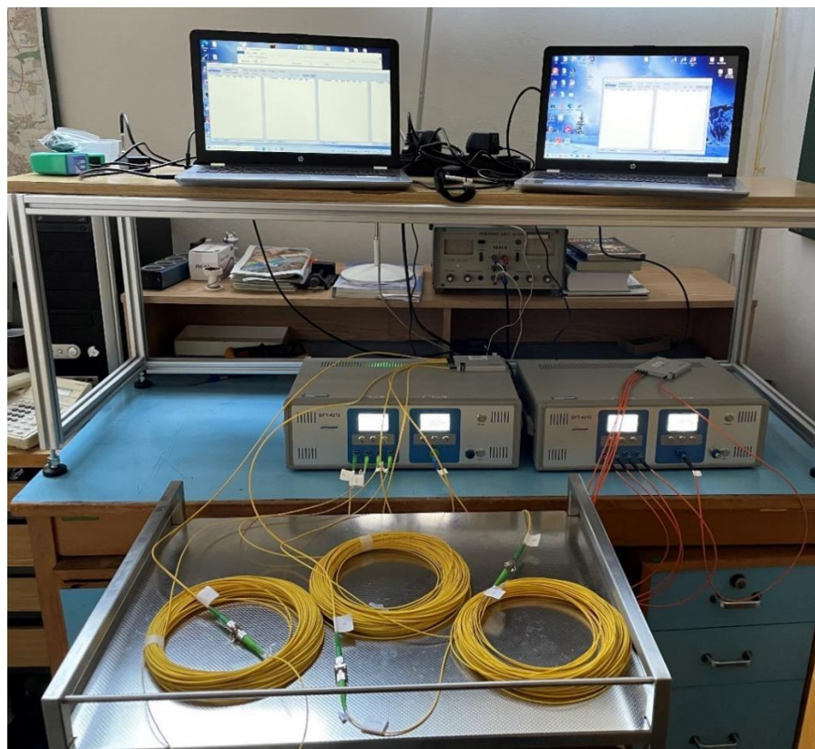
Obrázek 7: Fotografie měřicího pracoviště vybaveného zařízením OPTOKON OFT-4212. Vlevo pro měření SM vláken a vpravo pro měření MM vláken.
