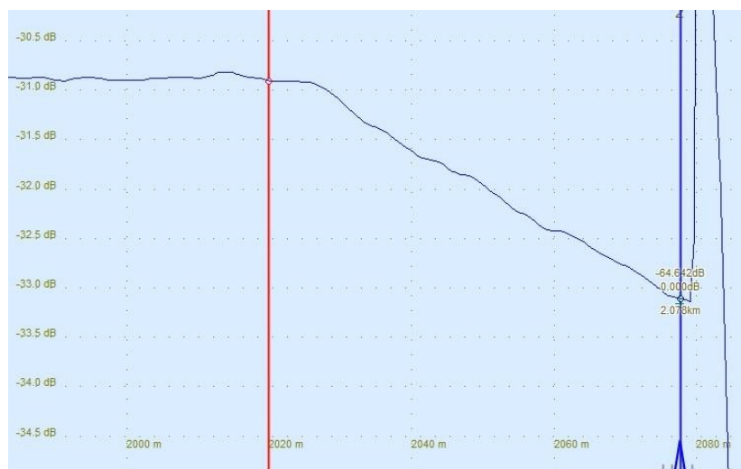
Obrázek 25: Výsledek měření metodou OTDR. Snímek z programu TopOTDRViewer pro vlákno 1 a vlnovou délku 1310 nm.
