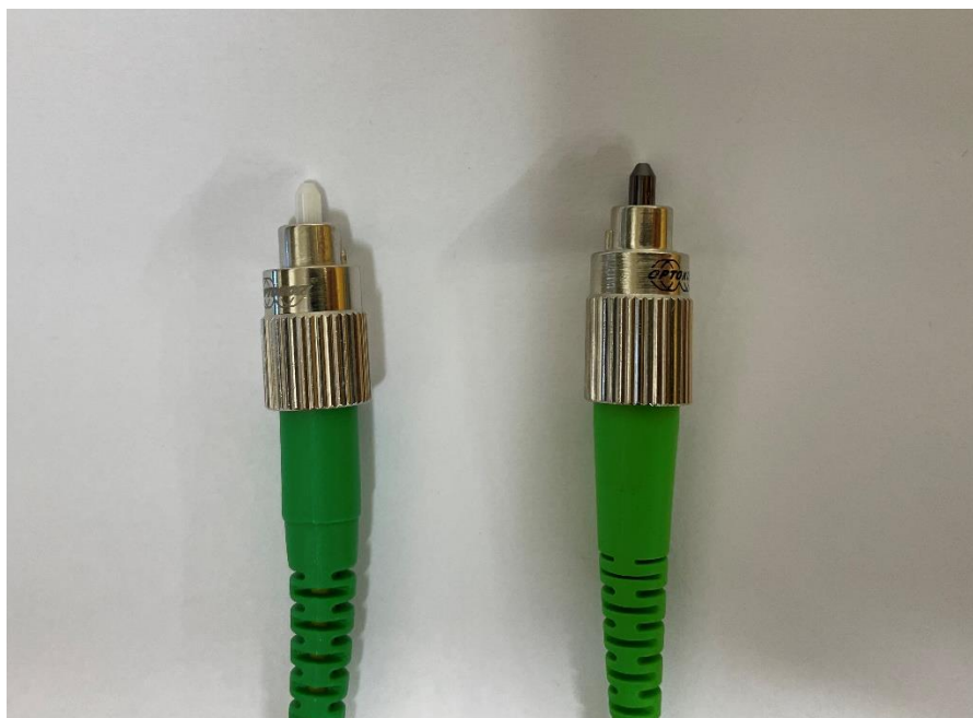
Obrázek 14: Porovnání barvy zakončení vláken před ozářením vlevo a po ozářením vpravo.
