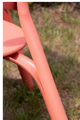
Obr. 104 detail rozříznutí trubky u křesla, 5/2022
