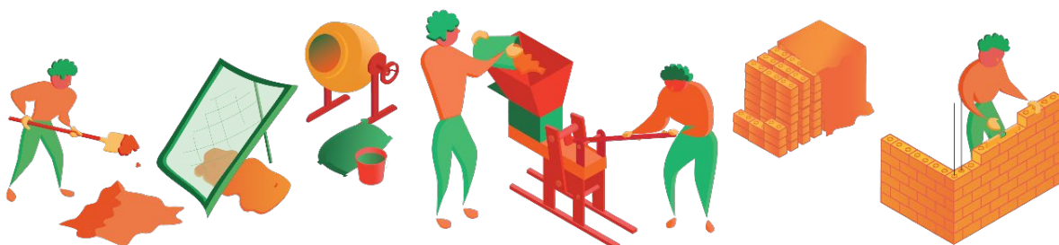
Obr. 23 Postup práce: Preosiatie hliny, zmiešanie s vodou, cementom a ílom, zlisovanie, vysychanie a murovanie, grafika autorky 2022
