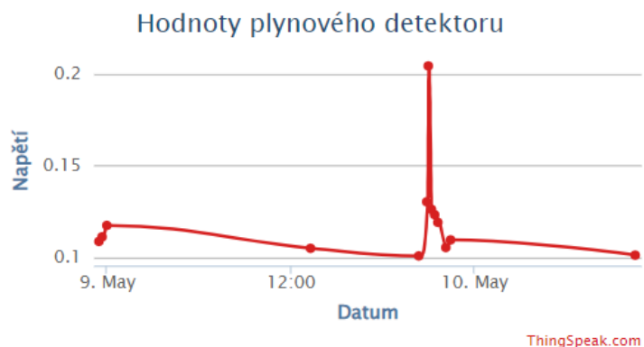
Obrázek 30: Záznam napětí na analogovém výstupu z plynového detektoru
