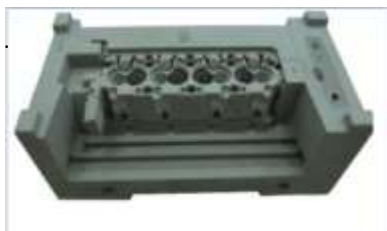
Obrázek 3. Polovina pískové formy vytištěná technologií sandprint.
