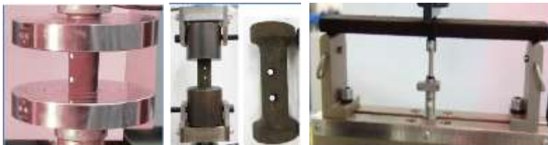
Obrázek 8. zkoušky pevnosti upravených a neupravených vzorků tištěných struktur
