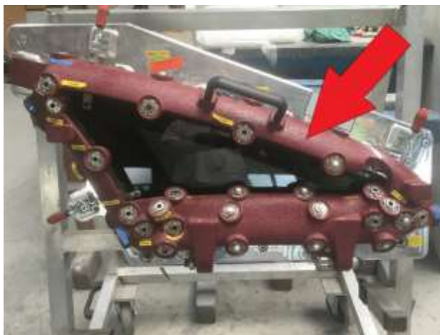
Obrázek 9. ukázka dílu přípravky vyrobeného technologií sandprint
