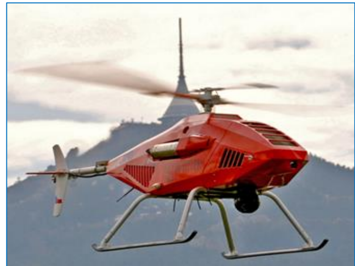
Obr.12: Bezpilotní vrtulník SkySpotter 151 vyrobený za použití technologie sandprint (MTOW: 150kg)
