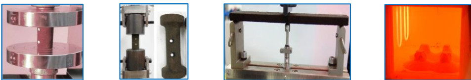
Obr. 6: Mechanické zkoušky v tlaku, tahu a ohybu a zkouška teplotní odolnosti
