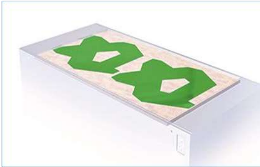
Obrázek 17: Sandprint – vytištěná plocha jedné vrstvy písku [9]
