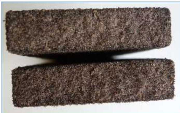
Obrázek 83: Lom tyčinkou s dostatečným prosycením
