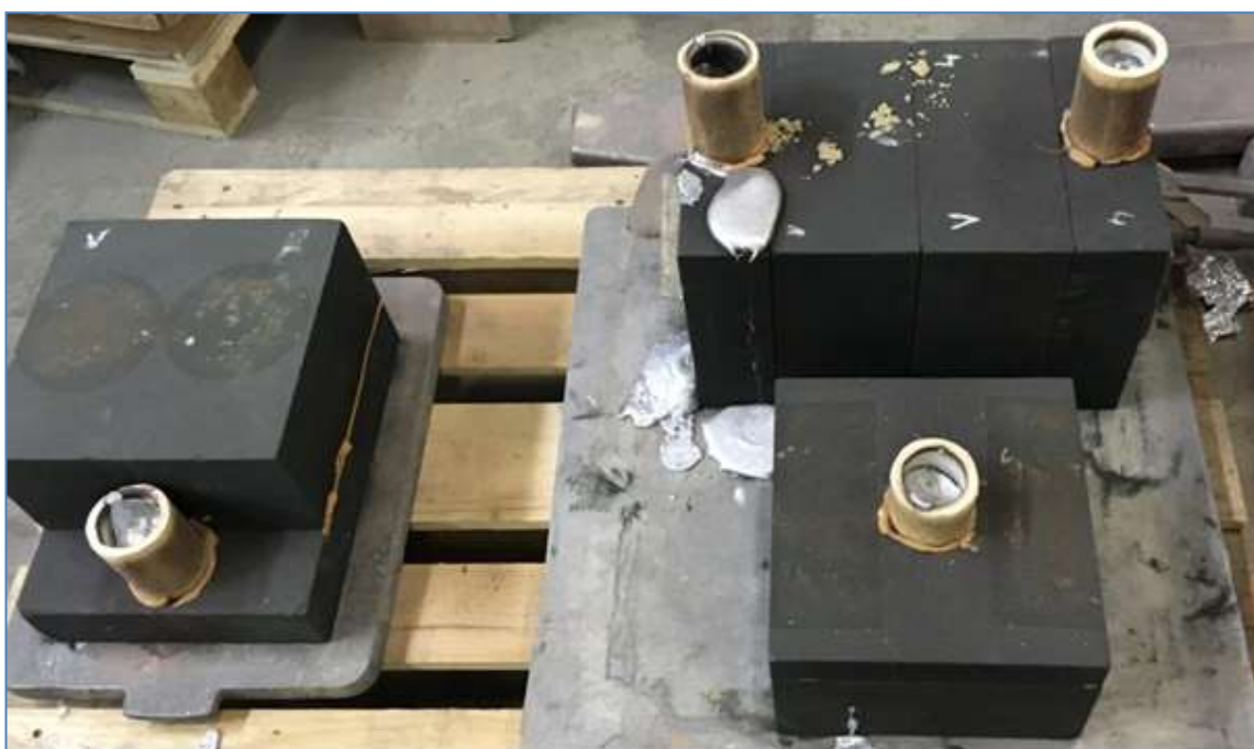
Obrázek 63: Testovací formy po odlití
