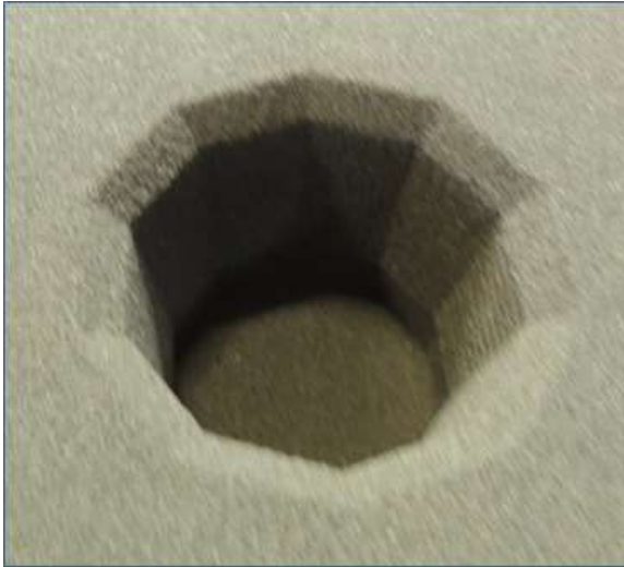
Obrázek 27: Příklad chyby zaviněné špatnou prací s daty
