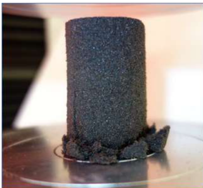
Obrázek 95: Struktura lomu napuštěného zkušební vzorku (pryskyřice WR 90N)
