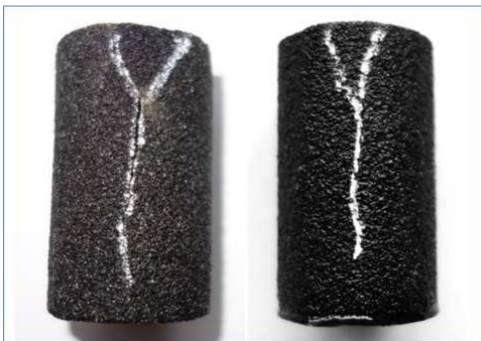
Obrázek 97: Struktura lomu napuštěného zkušebního vzorku (pryskyřice Epolam 5015)
