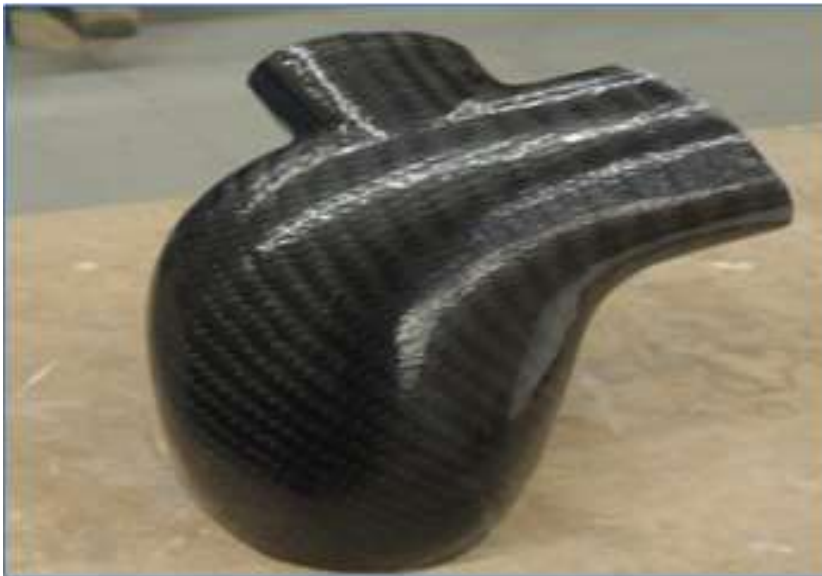
Obrázek 114: Kompozitový díl vyrobený za pomoci nevyztuženého modelu
