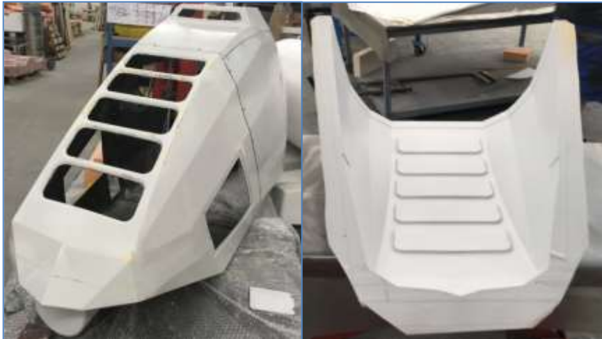
Obrázek 115: Laminovací forma na výrobu kapotáže vrtulníku vyrobená technologií sandprint (vlevo) a vyrobený kompozitní díl (vpravo)
