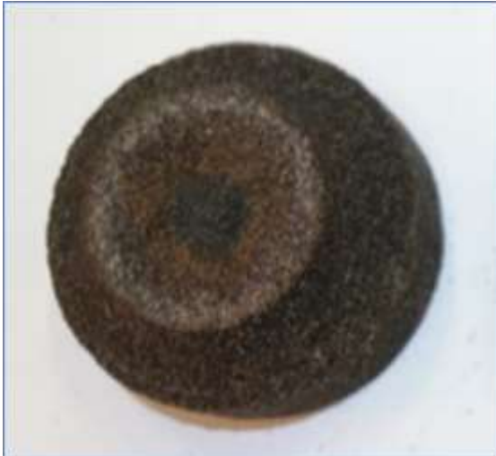
Obrázek 82: Lom tyčinkou s nedostatečným prosycením, uprostřed je místo bez pryskyřice
