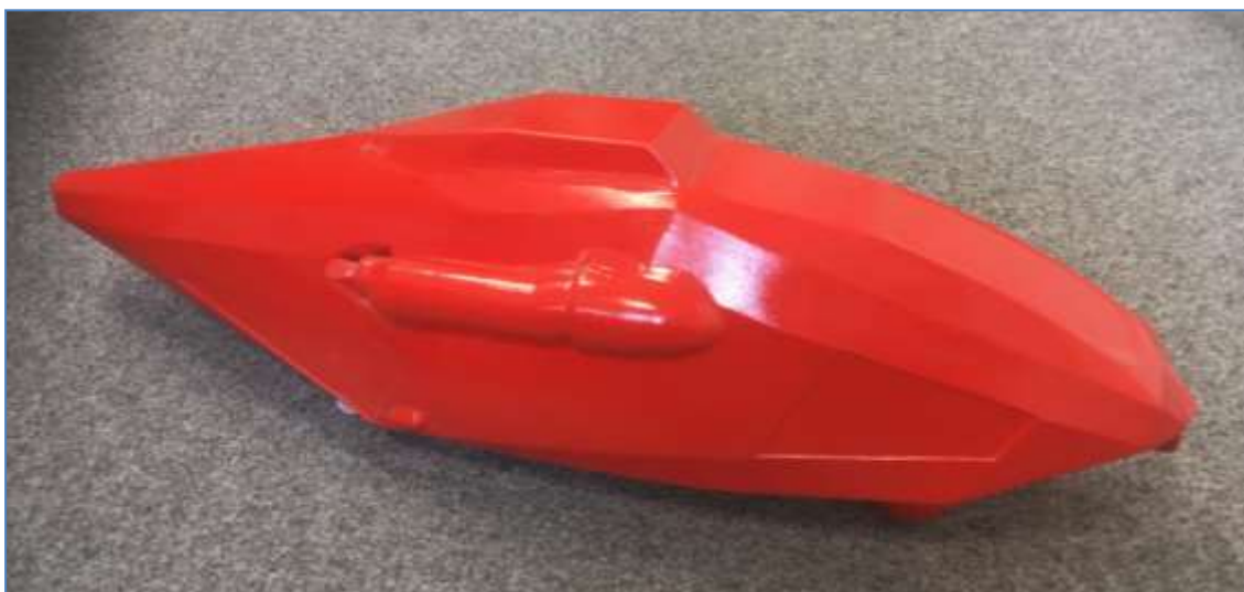
Obrázek 118: Maketa kapotáže SS151 vyrobená technologií sandprint určená pro test v aerodynamickém tunelu
