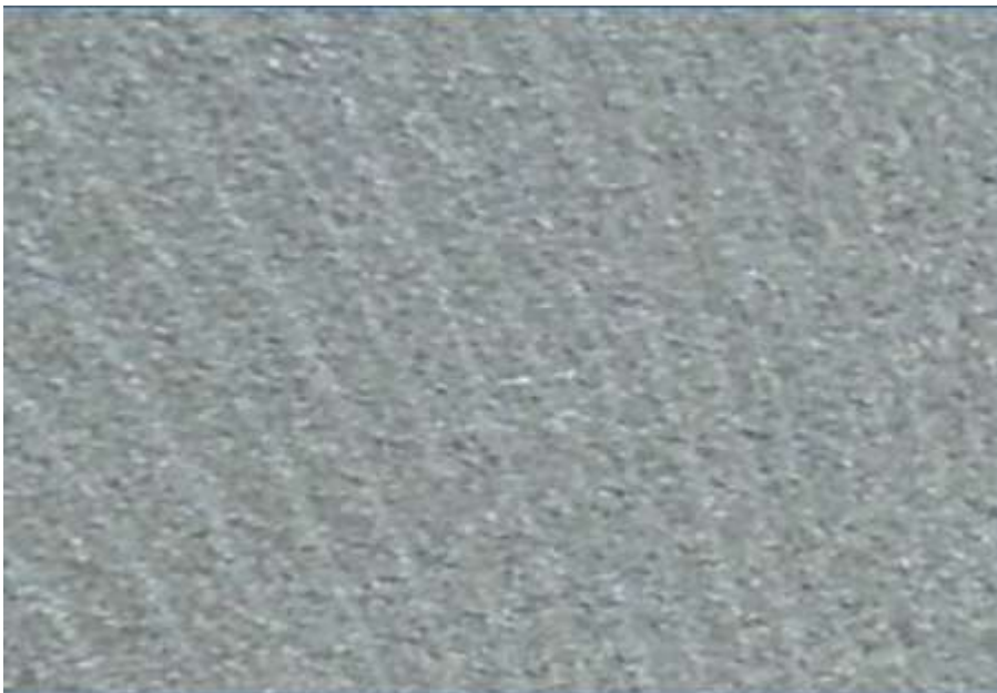
Obrázek 109: Schodovitá struktura povrchu tištěné pískové struktury
