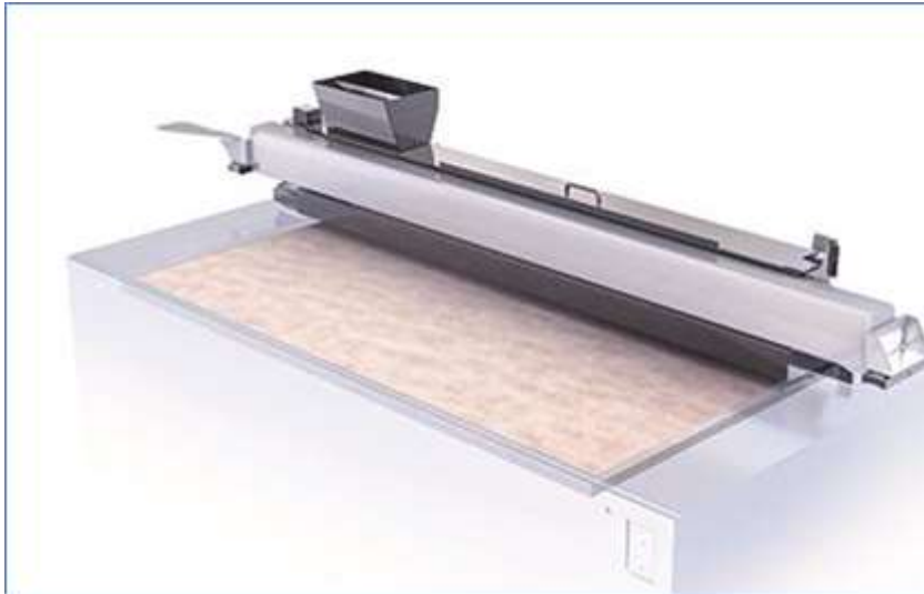
Obrázek 15: Sandprint – nanesení vrstvy písku s aktivátorem [9]
