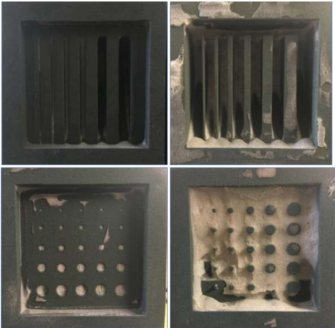
Obrázek 60: Vytištěné formy se zbytky nevytvrzeného písku sloužící jako podpora
