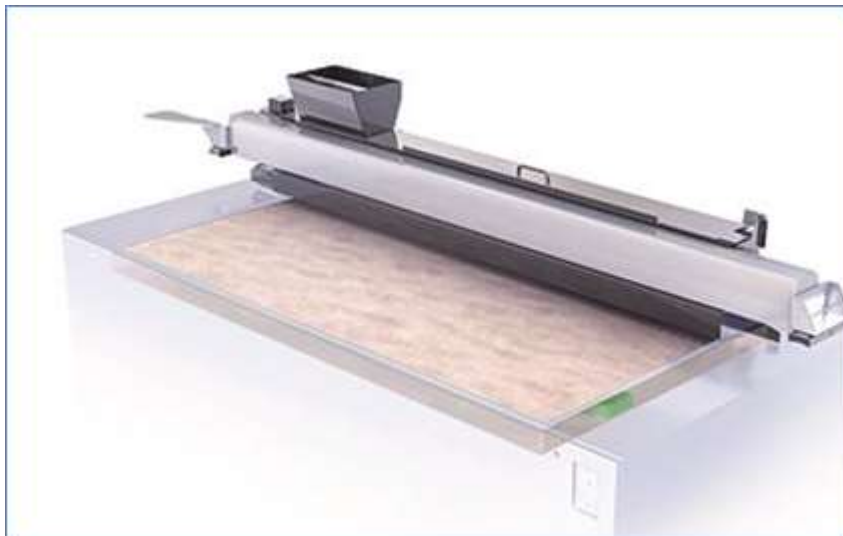
Obrázek 18: Sandprint – nanášení další vrstvy písku [9]
