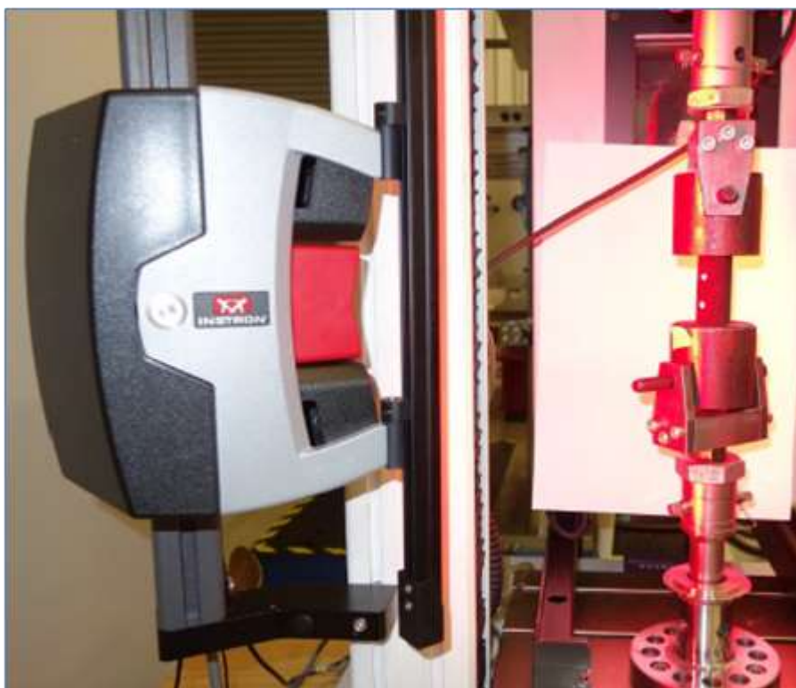
Obrázek 88: Uspořádání zkoušky tahem. Optický snímač a tyčinka upnutá ve zkušebním přístroji.
