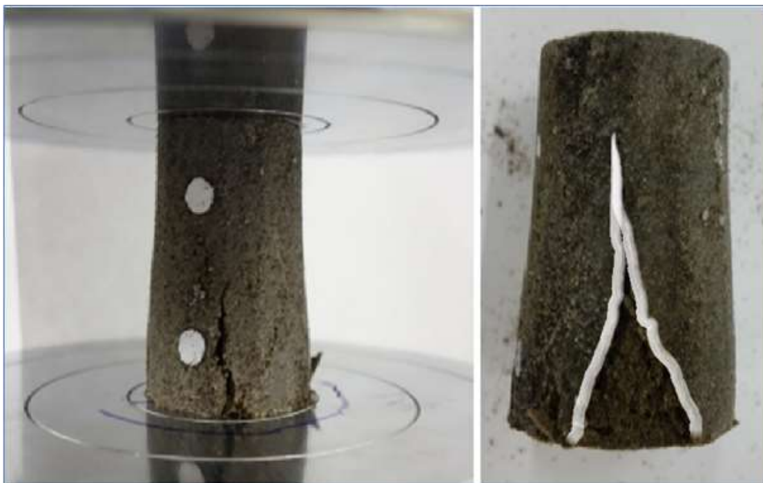
Obrázek 96: Struktura lomu napuštěného zkušebního vzorku (pryskyřice LG 735 Aero)
