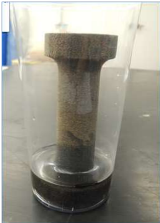
Obrázek 79: Zkušební vzorek v kelímku s pryskyřicí při zkoušce vzlínivosti a prosycení
