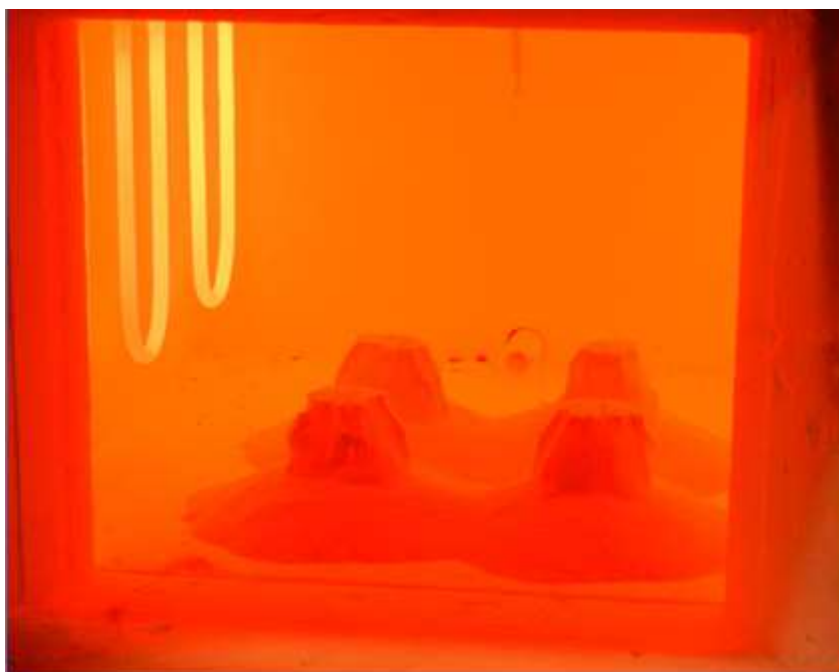
Obrázek 107: Rozpadající se zkušební vzorky v peci při teplotě 1 000 °C
