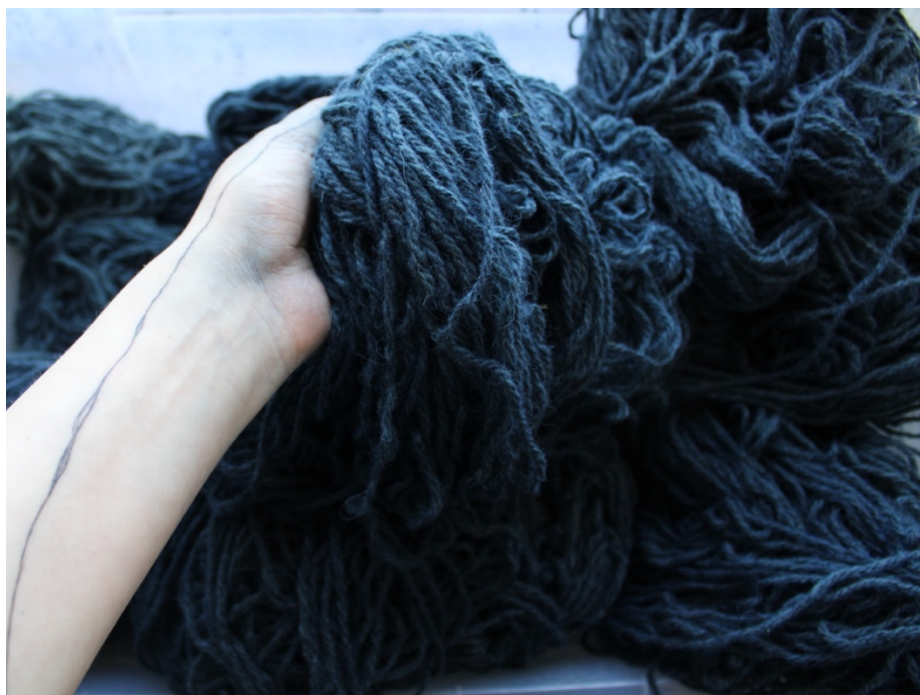
Obr.37: Schnoucí vlna po obarvení v indigu – viditelné tmavnutí
