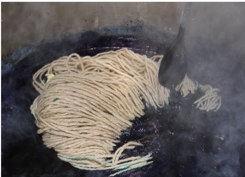
Obr.34: Ponořování namořené vlny do indigové lázně
