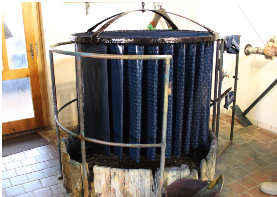
Obr.02: Namáčení potisklé metráže do indigové lázně
