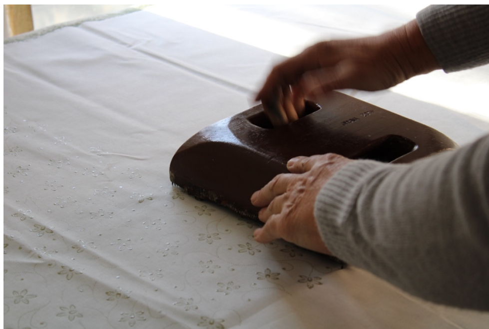
Obr. 01: Nanášení popu na látku pomocí dřevěné raznice s kovovým reliéfem
