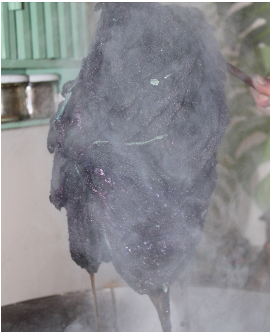
Obr.35: Vytažení příže z indigové lázně, viditelná tiskařská rezerva
