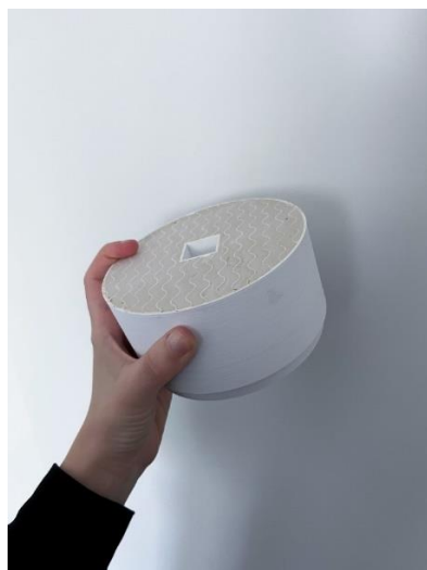
Obr. 33 forma vylitá sádrou
