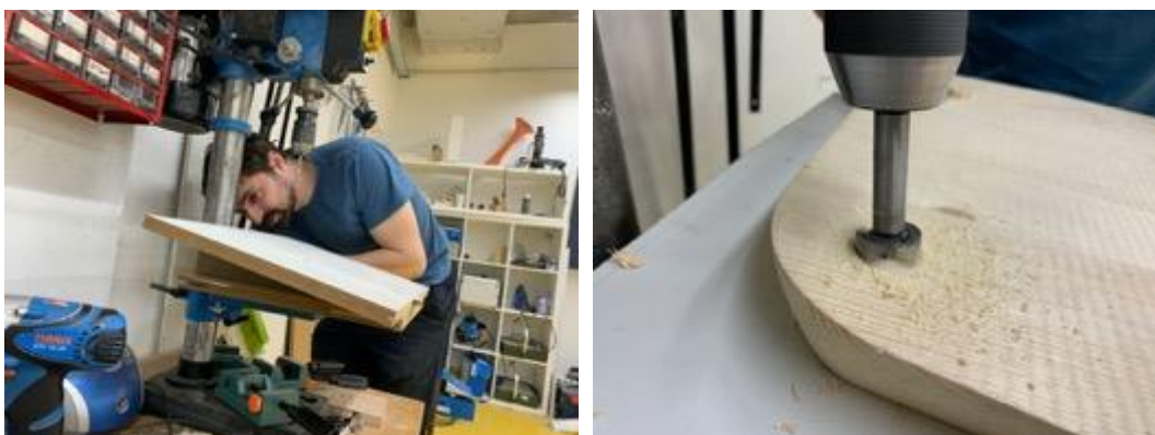
Obrázek 89: Vlevo náš dílenský Josef Majrych montuje přípravek na stolní vrták. Vpravo se již vrtá do sedáku.
