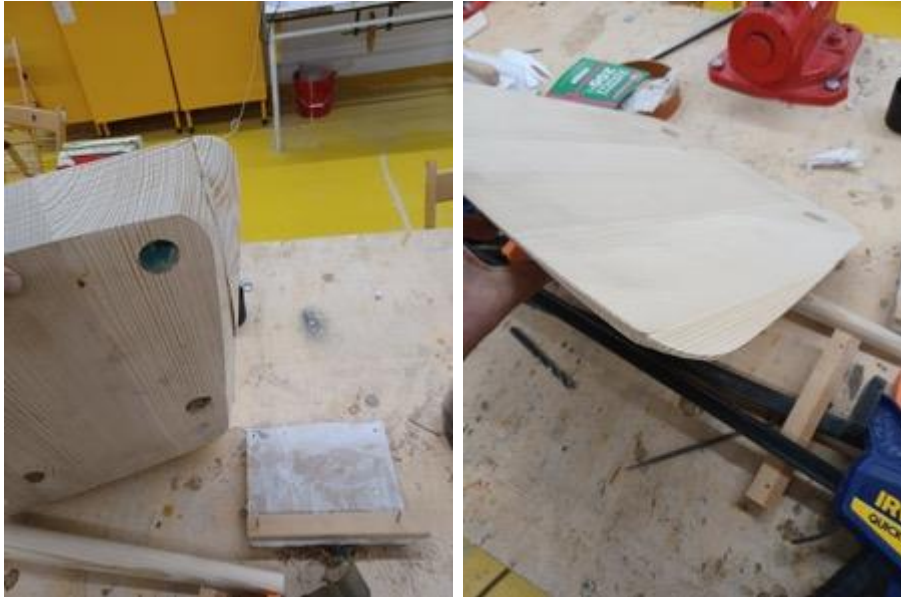
Obrázek 93: BEDNÁŘ, Miroslav. Opravená chybějící část sedáku, již ručně zbrošněná.
