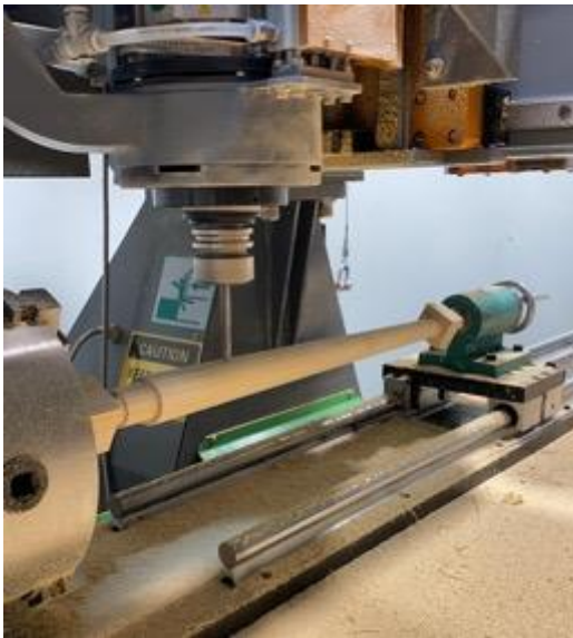
Obrázek 88: JÍNEK, Kryštof. Soustružení nohy židle.
