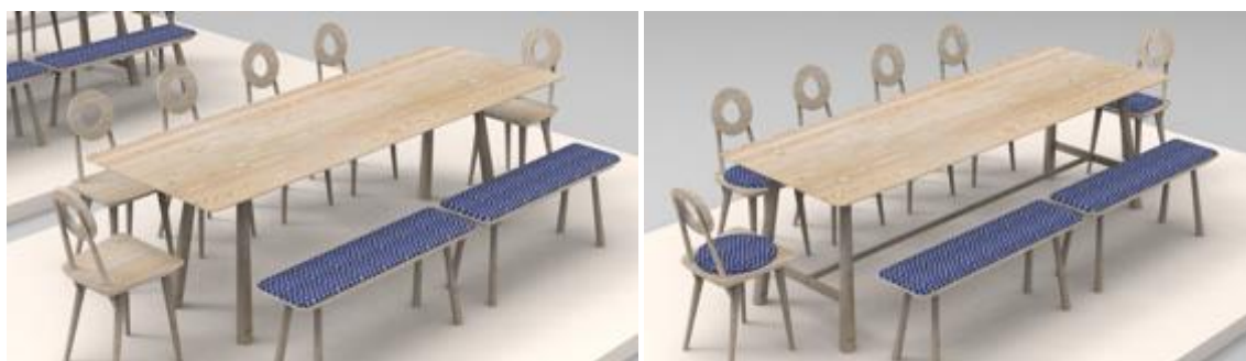
Obrázek 78.: Na obrázku lze vidět, že se nohy stolu propisují do desky stolu. Na obrázku vlevo je varianta bez spojovací trnože. Nohy budou u výsledné varianty umístěny jako na obrázku vpravo, nebudou ale spojeny trnoží.
