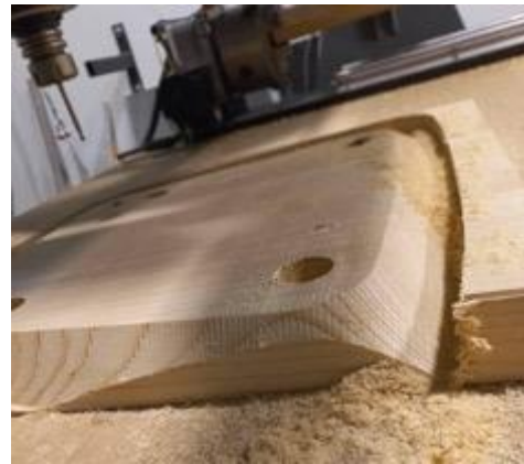
Obrázek 88: JÍNEK, Kryštof. Fotografie dokumentující frézování sedáku a menší chybu důvodu nedostatečně velkého materiálu pro frézování.
