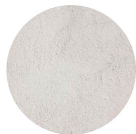
vápenná dvouvrstvá omítka (jádru + štuk)
