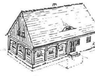
4. fáze: Nad podstávkou vztyčen krov nesoucí střechu s vikýřem.
