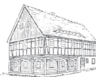
U patrového domu bylo mezi podstávkou a krov vloženo hrázděné, někdy raubené patro, později zdobené a současně zateplené břidlicovými čablonami.
