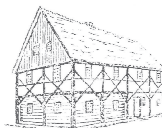
U patrového domu bylo mezi podstávkou a krov vloženo hrázděné, někdy raubené patro, později zdobené a současně zateplené břidlicovými čablonami.
