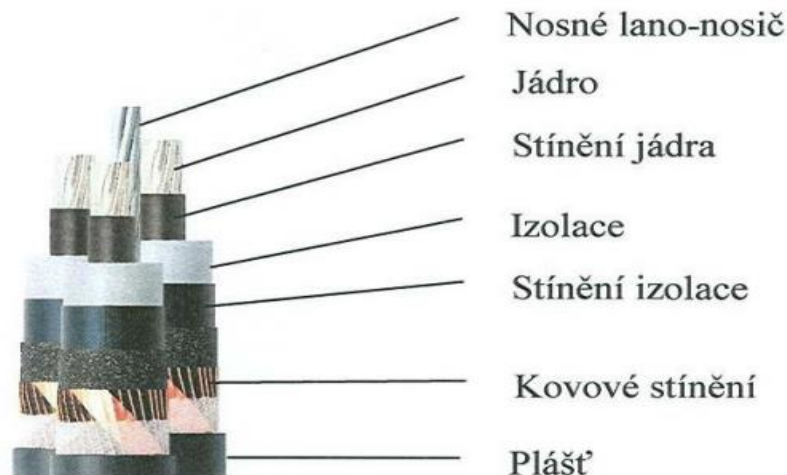
Obr. 1-7 Složení závěsného kabelu. 19
