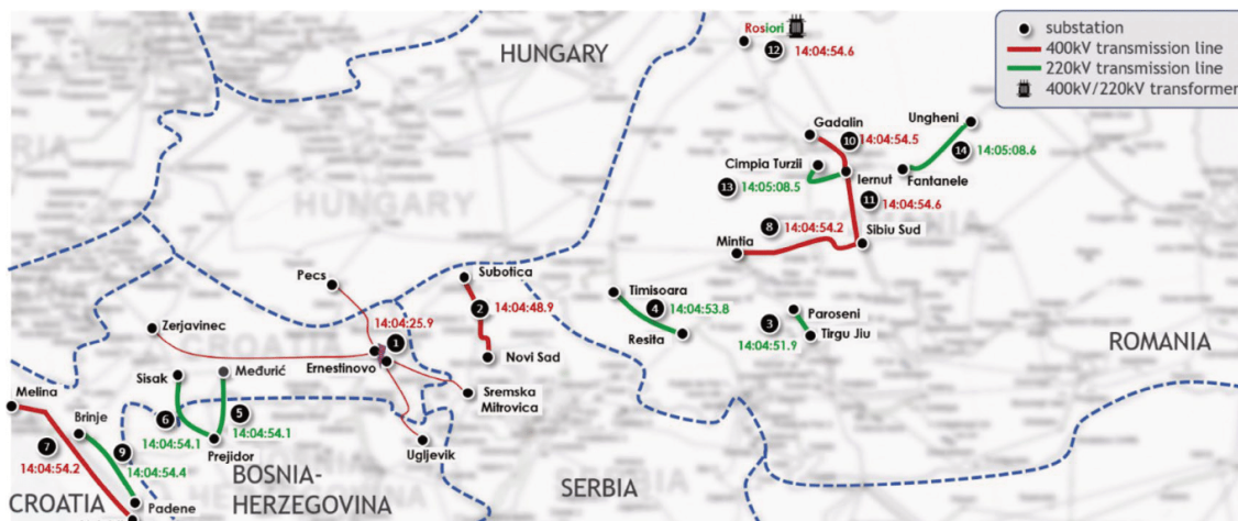
Obrázek 3.2. Lokace vypnutých přenosových prvků. Převzato z [31]
