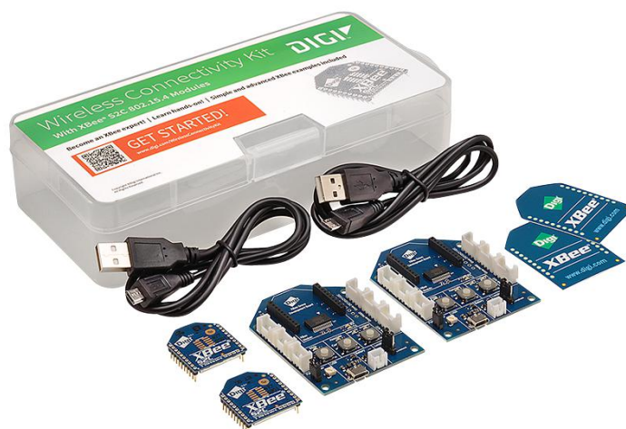
Obrázek 1.10: Vývojová sada Xbee Wireless Connectivity Kit [12]
