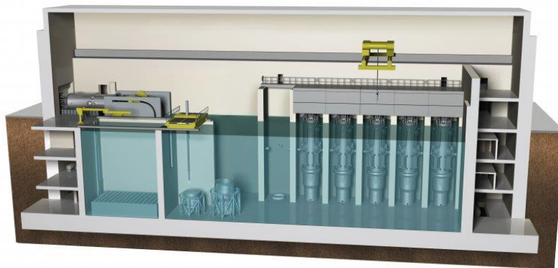
Obr. 4.2: NuScale budova reaktoru 29
