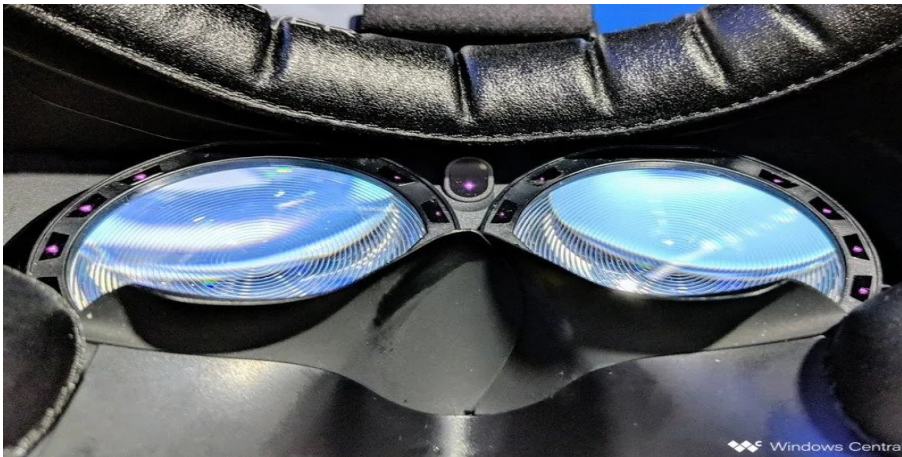
Obrázek 3.2: Obroučky okolo čoček zajišťující sken očních pohybů [15]
