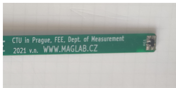
Obr. 2.10: Tvar hallovy sondy uvnitř pouzdra a její osazení na desce
