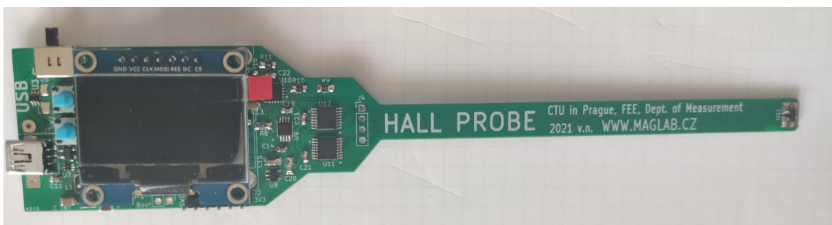
Obr. 2.9: Osazená sonda připravená pro firmware
