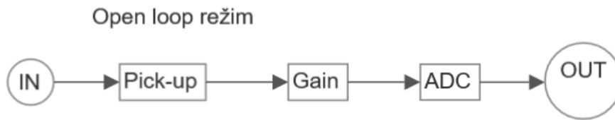
Obrázek 3.5: Blokové schéma zapojení fluxgate senzoru v provedení otevřené smyčky. Pick-up je snímací cívka, Gain je zesílení.
