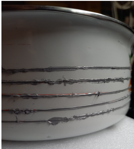
Obrázek 21: Vlákno namotané na hrnci na vrstvě teplovodivé pasty.
