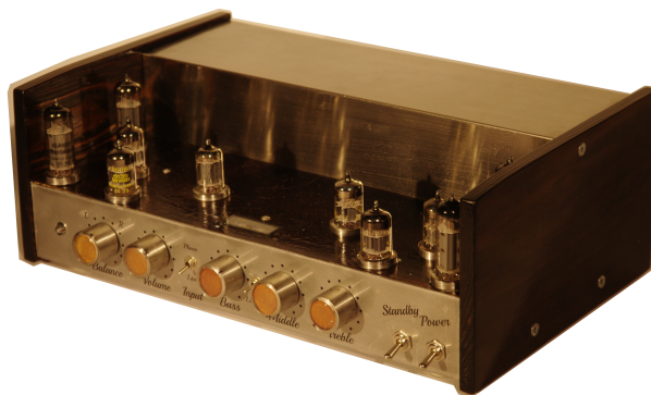
Obrázek 31: Zesilovač využívající vakuové prvky.
