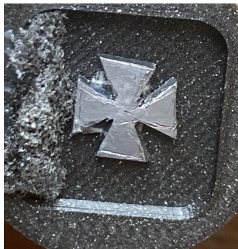
Obrázek 2.11: Olověný křížek, který byl ozářen izotopem ^{241}\text{Am}
