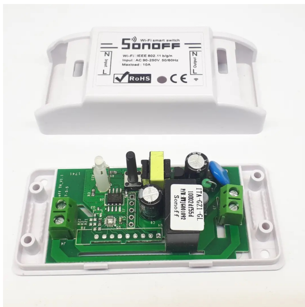
Obrázek 4.3. Spínač Sonoff Basic [27]
