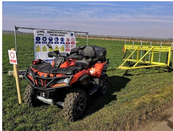
Obrázek 19 Nosný systém obsahující šest měřících sond
