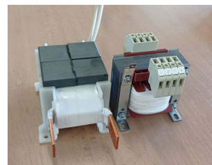
Obrázek 1.4: Zleva: feritový transformátor 5.1 kVA, vzorový transformátor 63 VA
