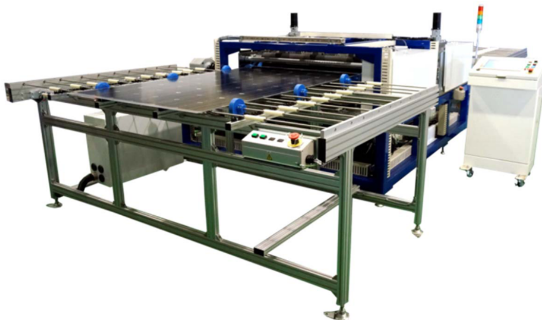
Obrázek 6.6. Zařízení pro separaci skla od zbytku PV modulu metodou řezání horkým nožem [55].
