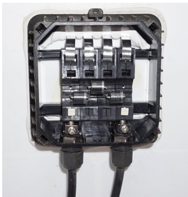
Obrázek 2.3. Vnitřek připojovacího boxu se třemi překlenovacími diodami [3].
