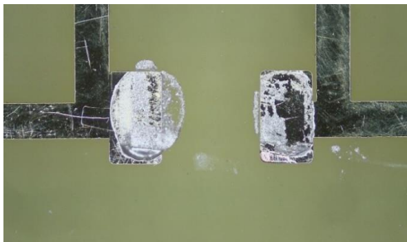
Obr. 25 Utržený rezistor, ELPOX SC 515, zlato
