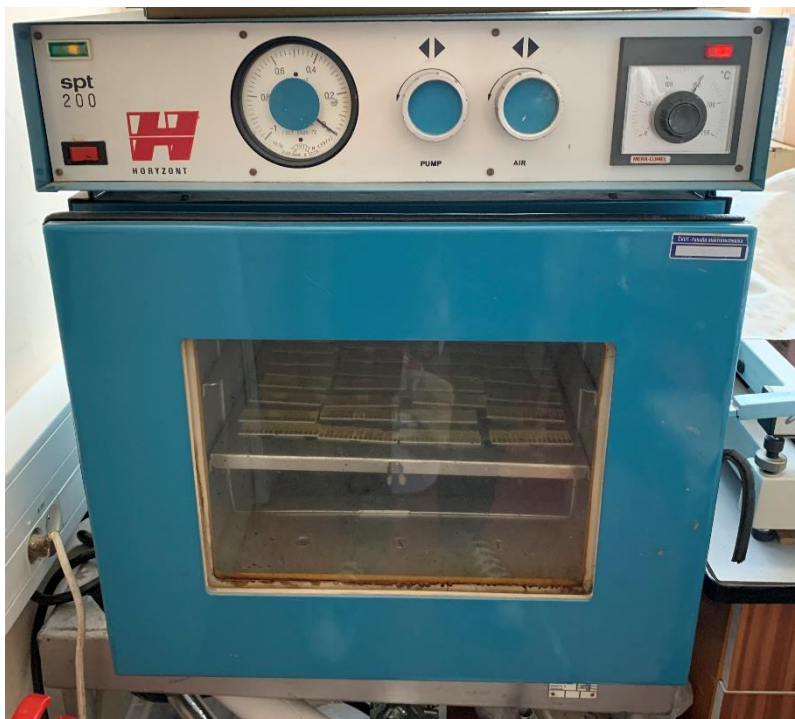
Obr. 15 Horkovzdušná pec při vytvrzování sady vzorků
