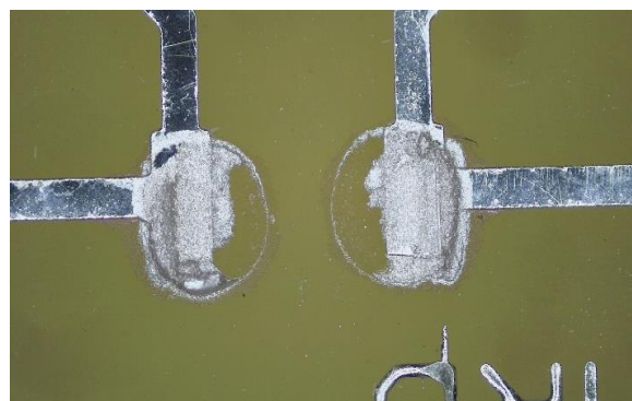
Obr. 37 Utržený rezistor, ELPOX AX 70MN, cín (HAL)
