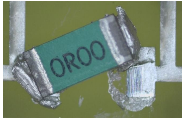
Obr. 23 Rezistor po zkoušce adheze neopustil svou pozici na DPS
