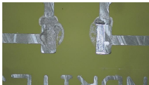
Obr. 47 Utržený rezistor, ELPOX AX 15N, cín (chemický)
