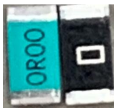
Obr. 20 Vlevo rezistor pro lepení, vpravo rezistor pro pájení
