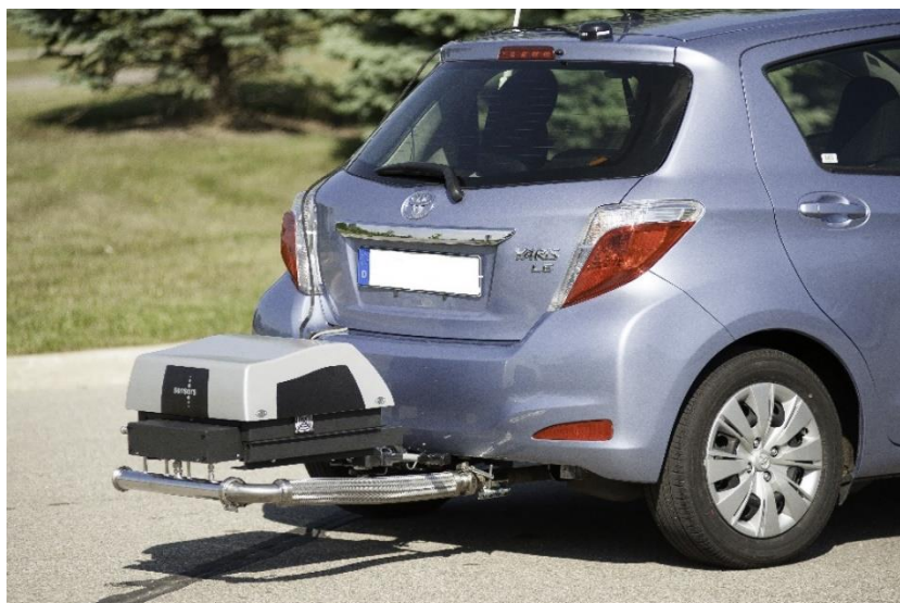
Obrázek 8.3 Zařízení PEMS umístěné na vozidle [85]
