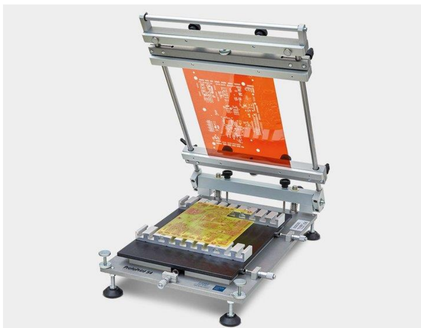
Obrázek 1 - Sítotisk pro laboratorní účely [10]
