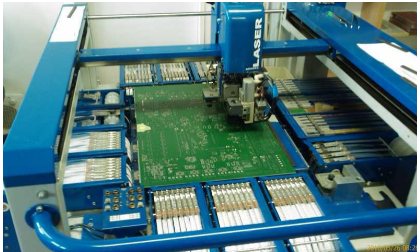
Obrázek 2 - Průmyslové osazování DPS [11]
