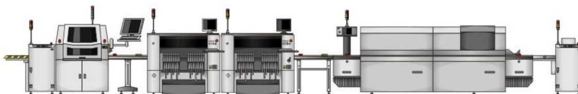
Obrázek 3 - Automatická pájecí linka [9]
