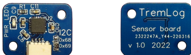
Obrázek 3.11: Osazený plošný spoj senzoru, horní (vlevo) a spodní strana (vpravo)
