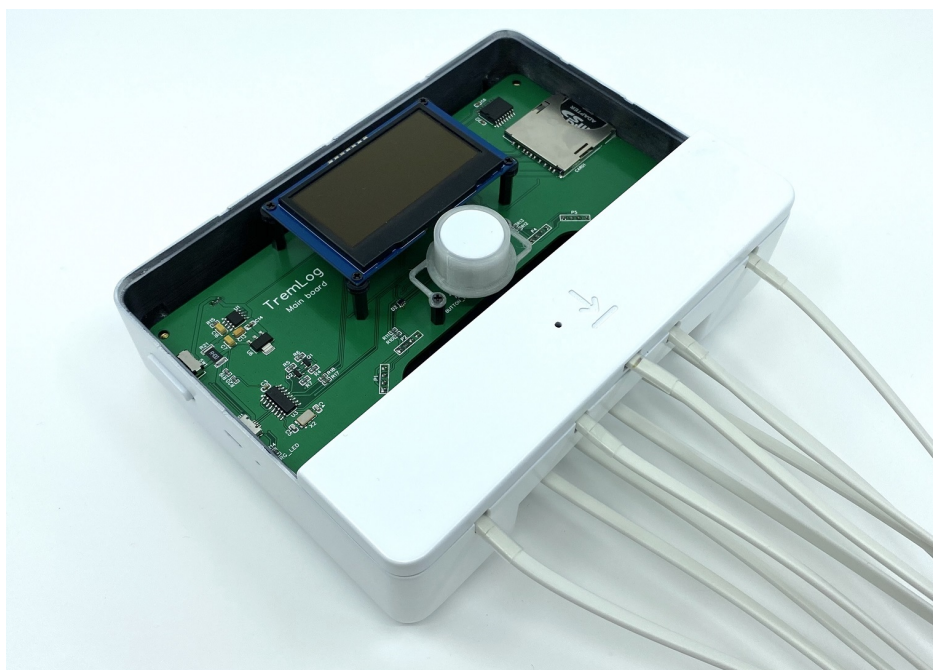
Obrázek 3.16: Otevřený kryt přístroje [3]. Organizér je zakryt senzorem.
