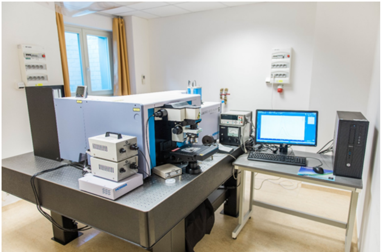
Obr. 10.4: Fotografie zařízení Labram, luminiscenční a ramanovský spektrometr.
