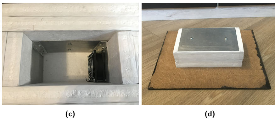
Obrázek B.4: Vnější chlazení zepředu (a), vnější chlazení shora (b), vnitřní chlazení s izolací (c) a víko (d) tepelné komory
