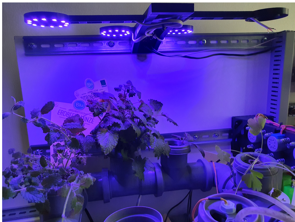
Obrázek 6.13: Výsledné použití 3D vytisknutého LED osvětlení nad hydroponickou farmou
