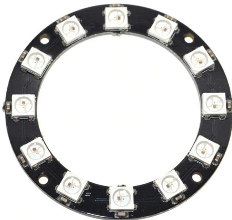
Obrázek 6.2: Kruhový modul NeoPixel s 12 WS2812B diodami zapojenými do série
