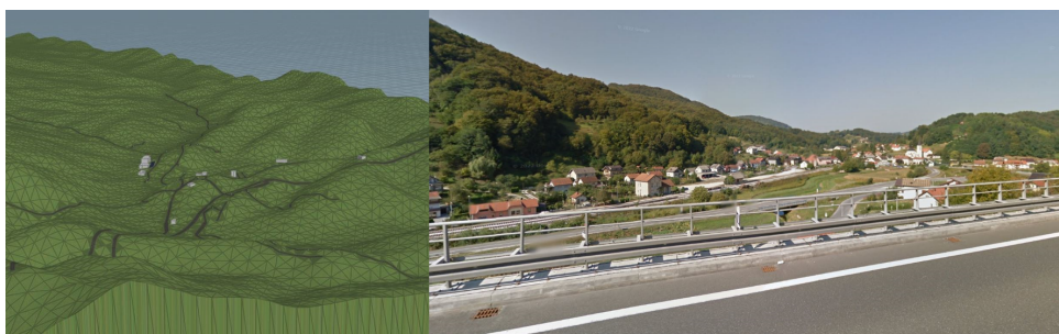
Obrázek 5.11: Příklad chybějících dat na obci Durmanec (Chorvatsko), kde vlevo vidíme vygenerovaný model z OSM dat a vpravo pohled Google Streetview, kde je jednoznačně více budov, než OSM data obsahovala).
