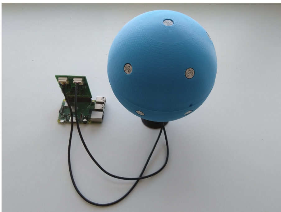
Obrázek 2.1: První verze mikrofonního pole s řídicí jednotkou.
