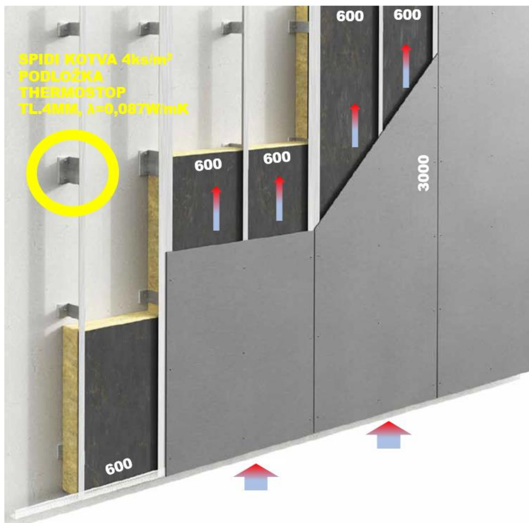
Obr. 26 - Schéma geometrie výpočtového modelu. Zdroj: autor
