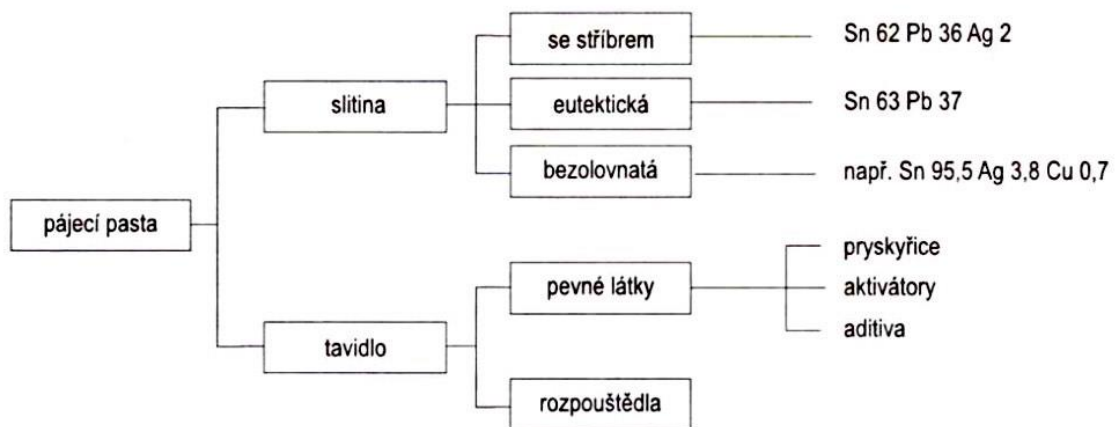
Obrázek 7 - Schéma složení pájecí pasty [1]
