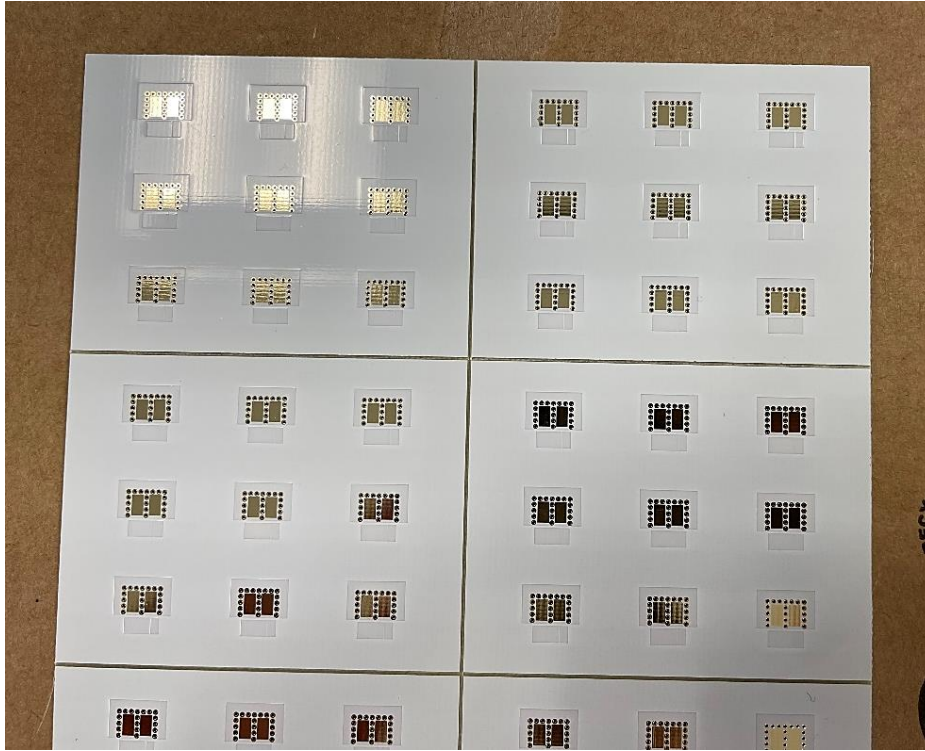
Obrázek 23 - Vyrobená DPS s vias a bílou nepájkivou maskou
