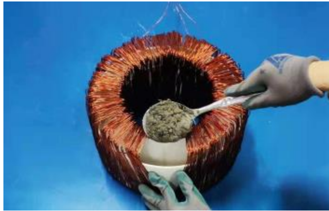
Obrázek 7: Plnění formy pro betonový válec cementovou směsí s ocelovými vlákny[7]
