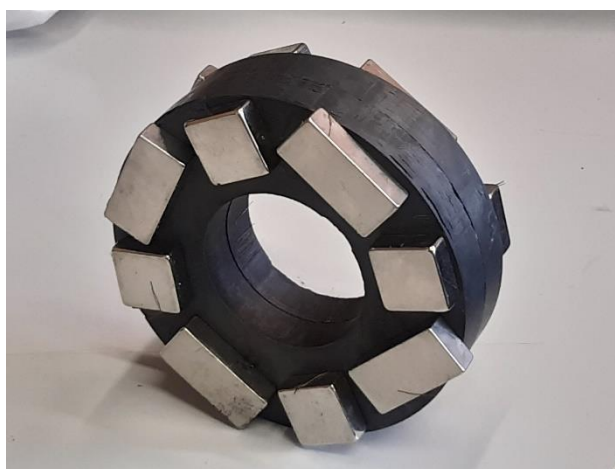
Obrázek 2: Magnetický toroid pro rovnání ferromagnetických vláken
