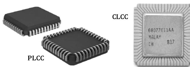
Obr. 7 – Příklad pouzder typu CC [27]
