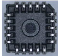
Obr. 28 – Pouzdro typu PLCC
