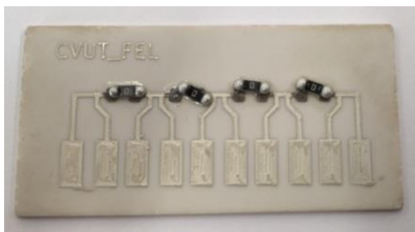
Obrázek 24 - Špatná smáčivost pájecích ploch.
