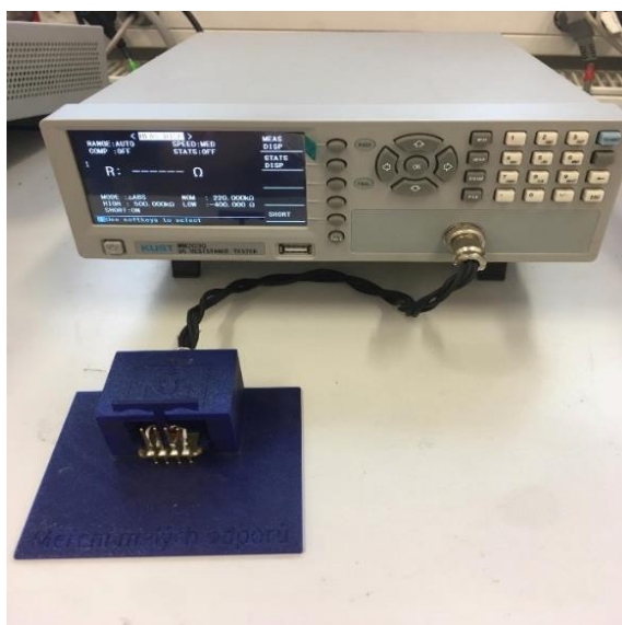
Obrázek 16 - Přístroj MM2030 pro měření malých odporů.
