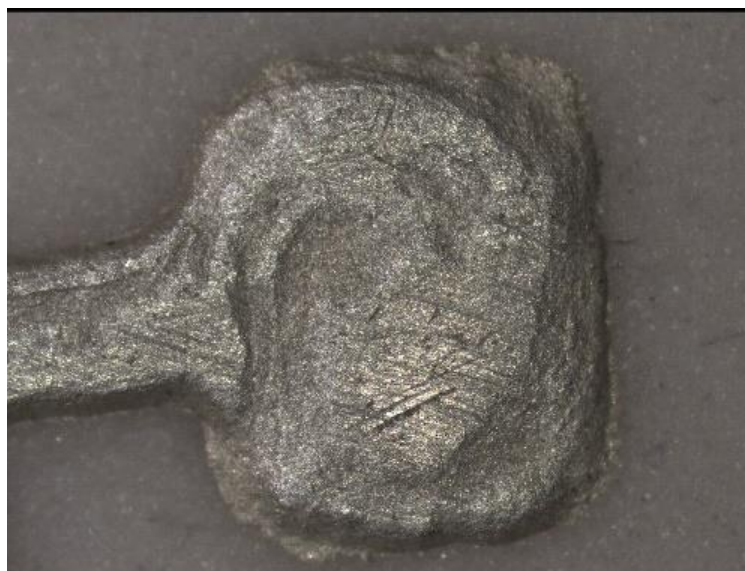
Obrázek 20 - Detail pájecí plošky po zabroušení.
