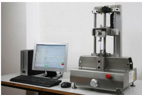
Obrázek 15 - Trhačka Deform použitá pro vyhotovení zkoušky stříhem.
