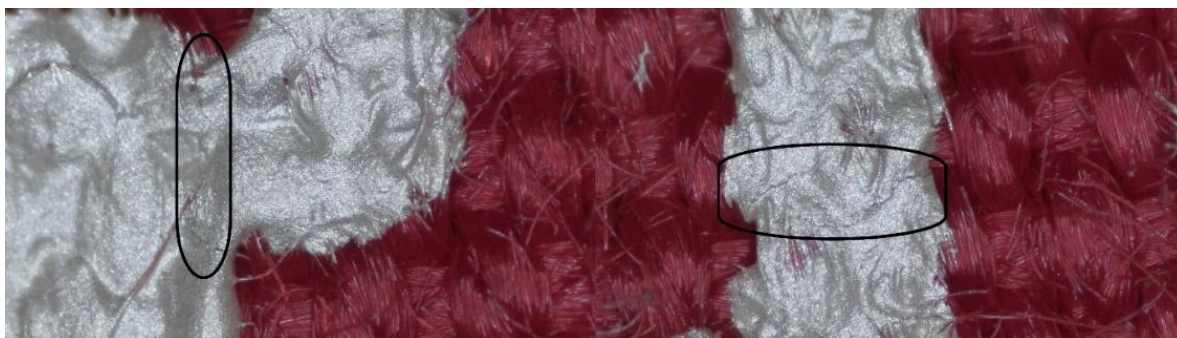
Obrázek 30 - Mikropraskliny na textilu.
