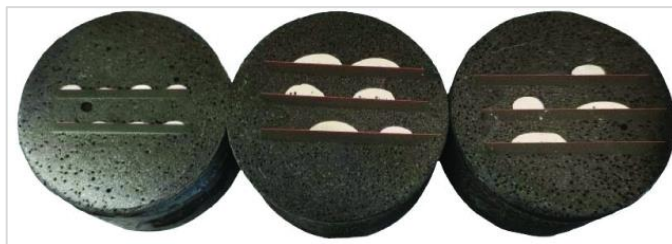
Obrázek 22. Metalografický výbrus zalitý vodivou epoxidovou pryskyřicí a připravený na analýzu na elektronovém mikroskopu (SEM). Převzato z [79].
