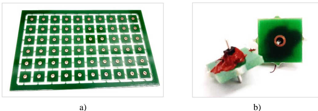
Obrázek 32. a) Navržená DPS pro původní experiment. b) Ukázka DPS s přilepeným pinem.
