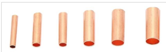
Obrázek 33. Trubičky použité v experimentu. Zleva průměr 2,2 mm, 2,5 mm, 3 mm, 4 mm, 4,5 mm a 5 mm.
