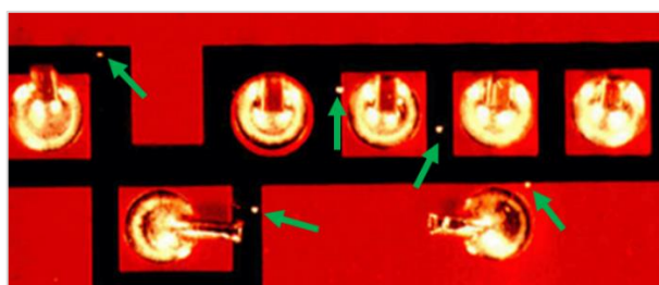
Obrázek 17. Výskyt kuliček pájky vlivem prskání slitiny z vlny. Převzato z [69].
