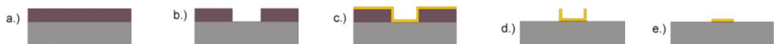
Obrázek 3.6: Lift off proces: a) pokrytí substrátu rezistem a následné vysoušení b) a) expozice a vyvolání rezistu c) depozice kovu d) lift off e) mechanické čištění a případné zarovnání hran. Převzato z [54].
