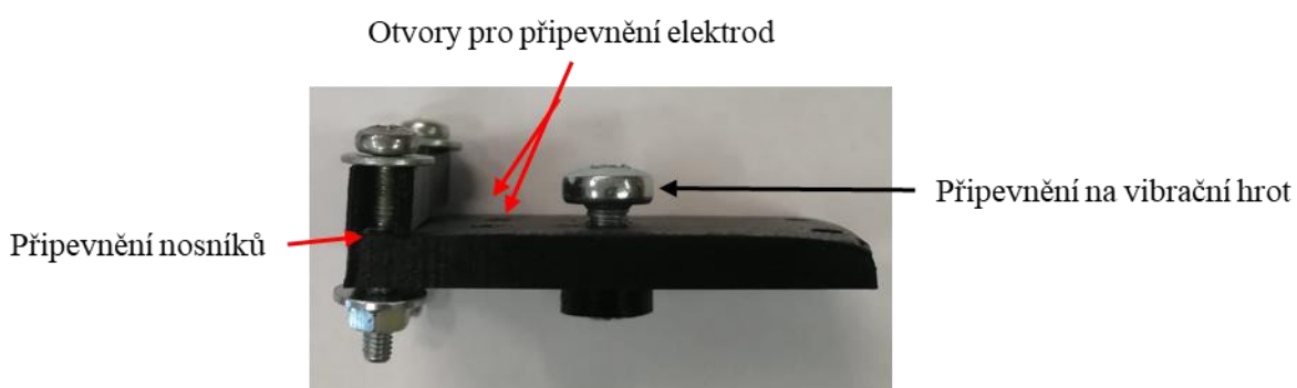
Obrázek 22 Vytištěný přípravek pro uchycení piezomodulu na hrot vibračního stolku – pohled ze strany.
